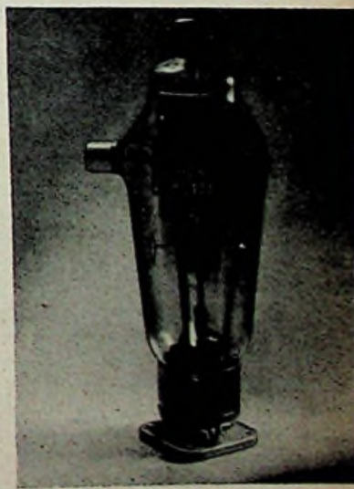
Bild 6. Thyatron oder Stromtor PL 105 für einen maximalen Anodenstrom von I = 6,4 A und einen maximalen Scheitelwert der Sperrspannung von \hat{U}_{max} = 250 V. Größte Länge 286 mm
